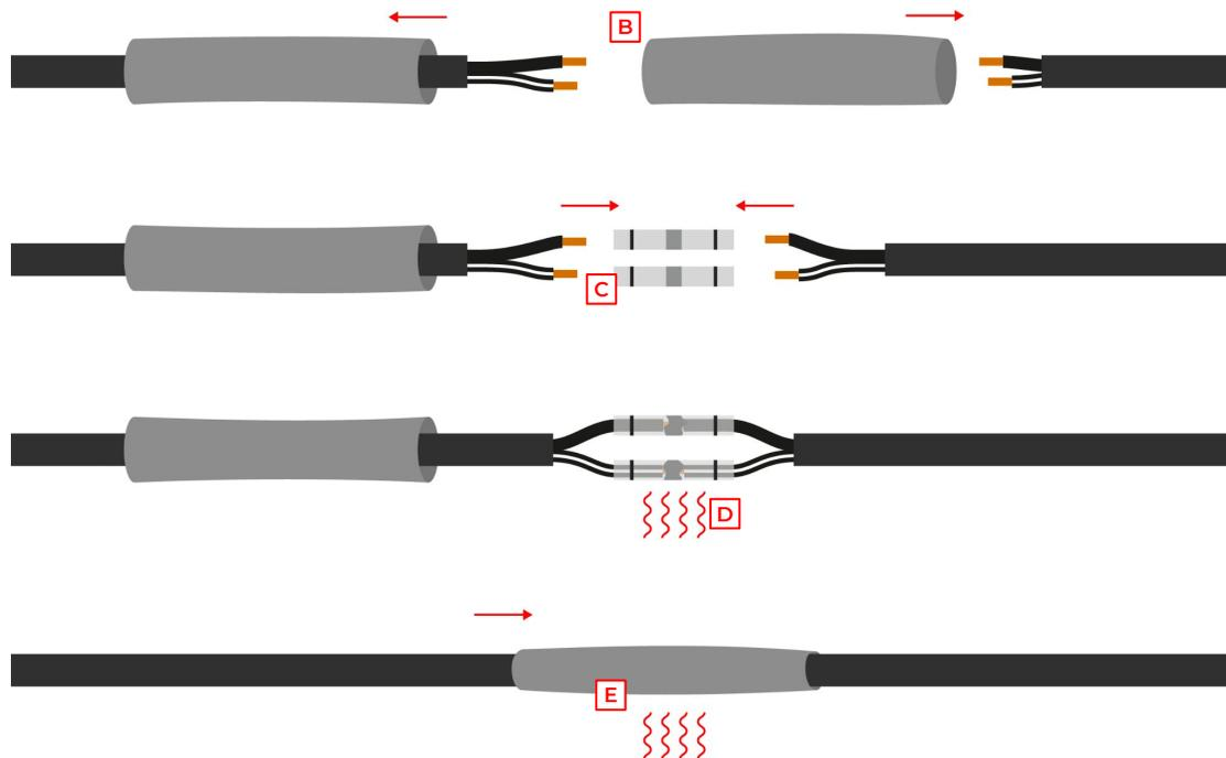
Schiebe die zwei Schrumpfschläuche über die Leitung **[B]**.
