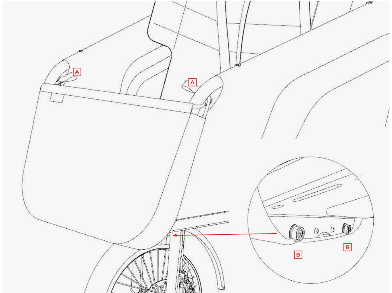
Hänge das Front Bag vorn in den Einstieg, indem du es unter die Frontlippe des Carriers führst und es links und rechts oben mit den Kordelschlaufen in die Rundknöpfe **[A]** im Hauptrohr hakst. Um die Schlaufen besser greifen zu können, besitzen sie jeweils eine Gurtlasche.
