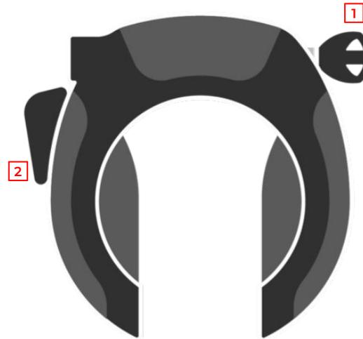
Drehe den Schlüssel [1] und drücke den Spannriegel [2] nach unten, um das Schloss zu schließen. Achte darauf, dass beim Schließen des Verriegelungsbügels [3] die Speichen nicht beschädigt werden. Sind dem Bügel Speichen im Weg, drehe das Vorderrad ein wenig.
