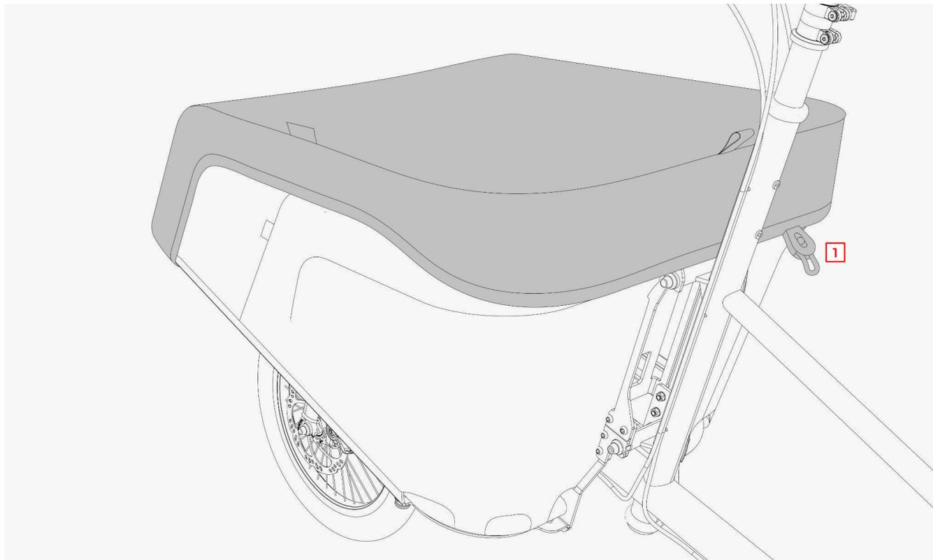
Stülpe das Roll Up Cover über den Family Up Carrier, so daß sich der Kordelstopper **1** hinten rechts am Carrier befindet. Mit diesem kannst du die Spannung des Gummizugs bei Bedarf nachjustieren.
