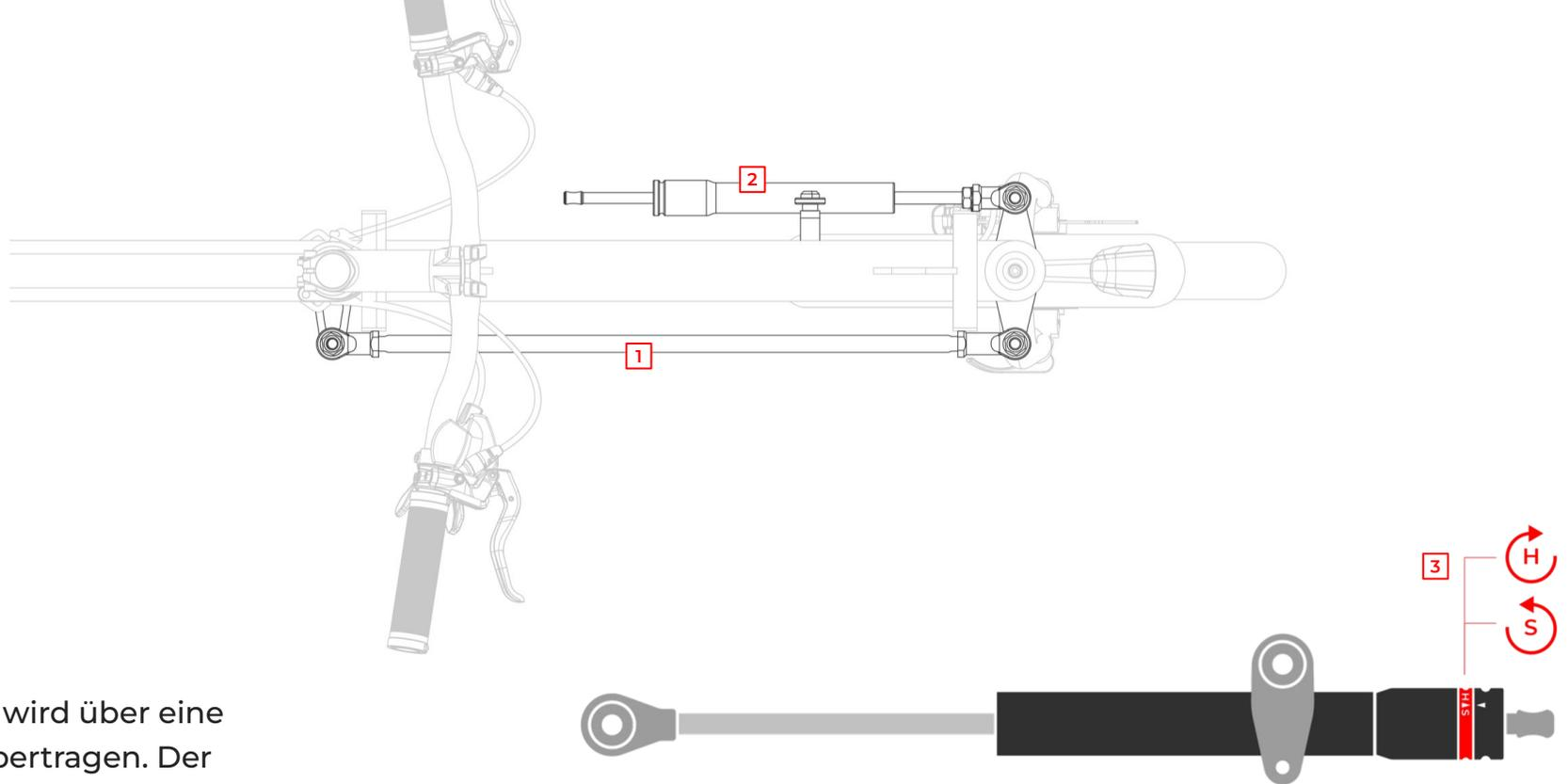
Die indirekte Lenkung wird über eine Lenkschubstange [1] übertragen. Der einstellbare Lenkungsdämpfer [2] bietet dir zusätzlichen Fahrkomfort.
