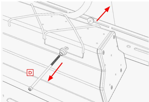
Der Family Up Carrier wird an drei Punkten mit dem Adapt-System verbunden.
