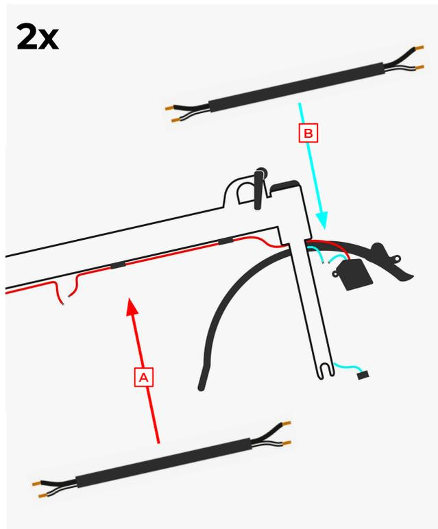
Entferne das Rücklichtkabel aus dem Kabelhalter unterhalb des Unterrohres. **[A]** Trenne die Kabelverbindung des Rücklichtes an dieser Stelle. Trenne das Dynamokabel **[B]** oben zwischen Gabelkopf und Frontleuchte.
