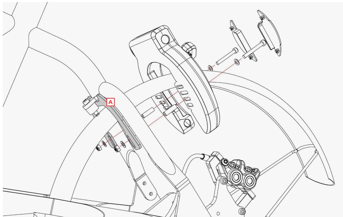
Positioniere das Rahmenschloss hinter dem Hinterbau. Führe die Schrauben wie dargestellt durch eine Unterlegscheibe, das Schloss, eine Distanzhülse, das Adapterblech, wieder eine Unterlegscheibe und eine Stop-Mutter. Ziehe Schrauben und Muttern zunächst soweit fest, dass sich Schloss und Adapterblech noch leicht verschieben lassen.
