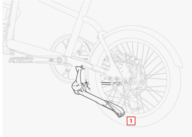
Um den Ständer zum Abstellen des YOONIT aufzuklappen, platziere deinen Fuß hinter eines der Ständerbeine [1]. Schiebe das YOONIT nach hinten, so daß sich der Ständer gegen deinen Fuß auffaltet. Hebe das YOONIT leicht an, um den Vorgang zu erleichtern.
