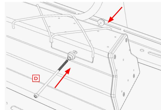
Führe zuletzt im Inneren des Carriers die Schraubachse durch die entsprechende Lochöffnung vorn am Tunnelblech in den darunter liegenden Aufnahmepunkt **[D]** am Unterrohr und ziehe ihn mit einem Inbusschlüssel Gr. 4 fest.
