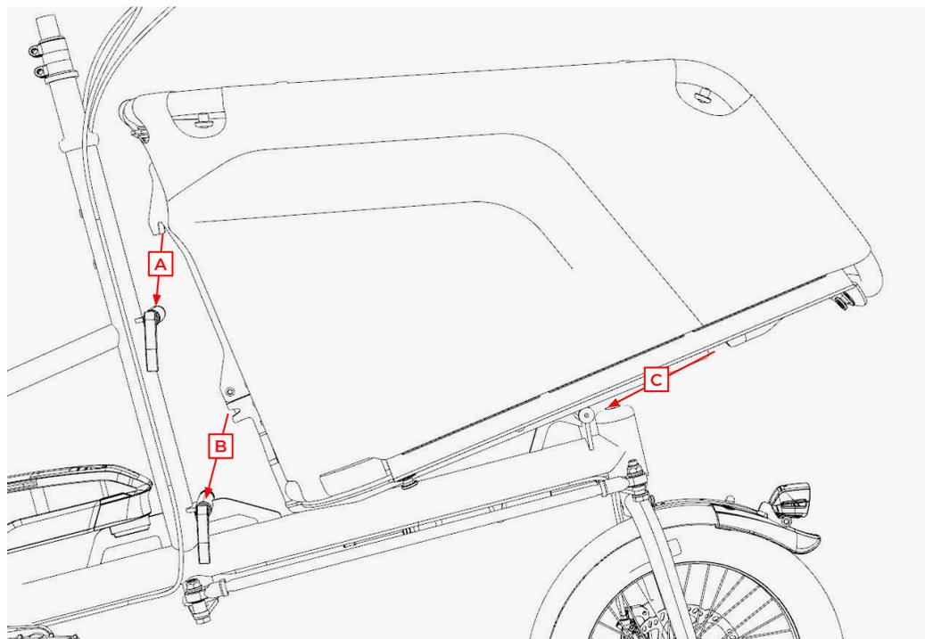
Um den Carrier zu befestigen, löse die hinteren beiden Schnellspanner **[A, B]** und entferne den vorderen Schnellspanner **[C]** am YOONIT.
