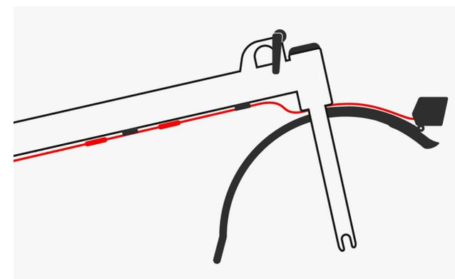
Anschließend kannst Du das Kabel wieder am Halter befestigen und den Scheinwerfer am neuen Frontlichthalter anbringen..
