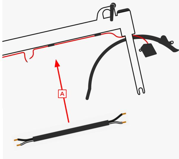
Entferne das Frontlichtkabel aus dem Kabelhalter unterhalb des Unterrohres. **[A]** Trenne die Kabelverbindung des Rücklichtes an dieser Stelle.
